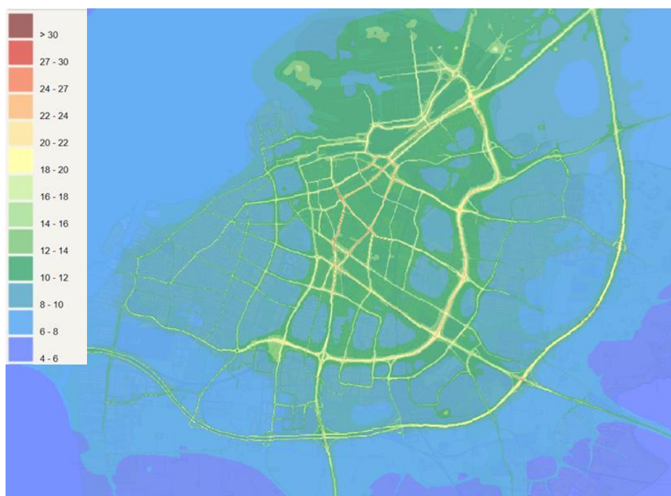
Figur 12. Beräknad årsmedelhalt av kvävedioxid (NO 2 ) på 2 meters höjd i Malmö, baserad på utsläppsdata från 2019. Enheten är mikrogram per kubikmeter (µg/m 3 ).
