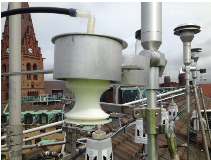
Filterprovtagare installerad på Rådhusets tak.
