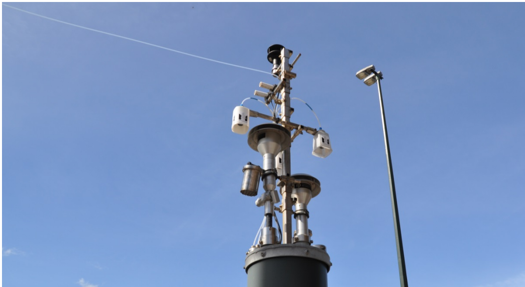
Provtagningssinlopp vid Dalaplan
